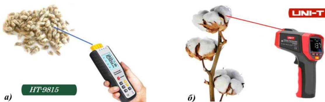
Рис. 2. а) Контактный термометр HT-9815; б) Бесконтактный термометр UNI-T UT303A
