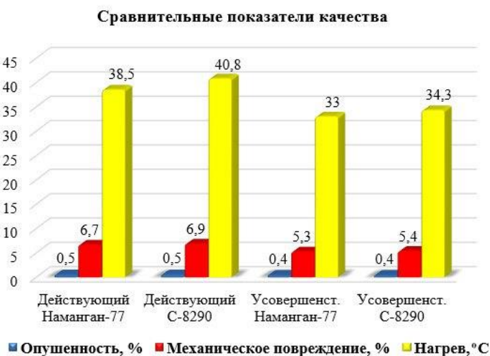
Рис. 25. Изменение механического повреждения, нагрева и остаточной опушенности семян при различной производительности в существующей и усовершенствованной делинтерной машине ОС
