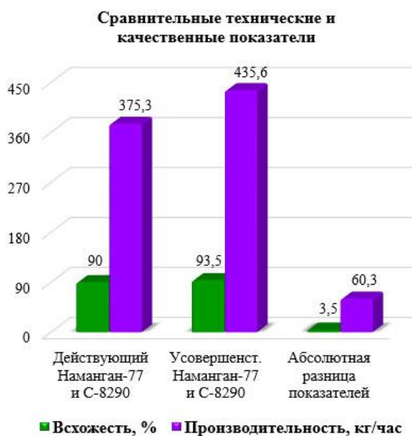
Рис. 26. Изменение средней производительности и всхожести семян у действующего, а также усовершенствованного делинтера ОС
