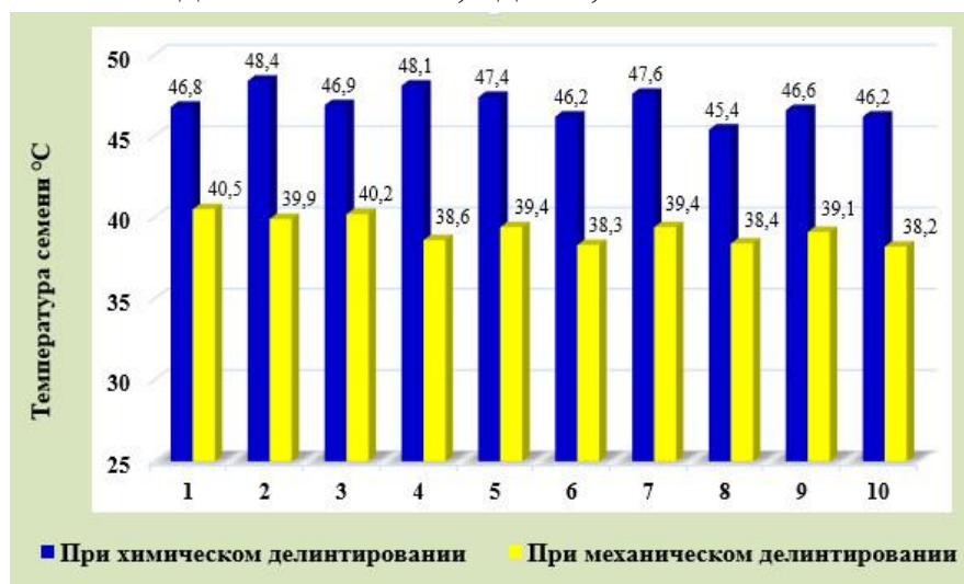
Рис. 3. Изменение температуры семян хлопка при механическом и химическом делинтеровании в существующей технологии делинтерования
