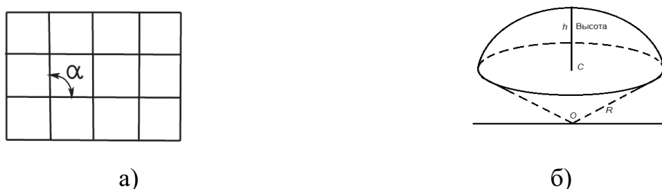
Рис.4.2. Измерение формоустойчивости деталей одежды, обработанных композиционным материалом: а- изменение показателей формоустойчивости угла \alpha между нитями основы и утка; б- состояние формообразования в заданной пространственной форме - h .
