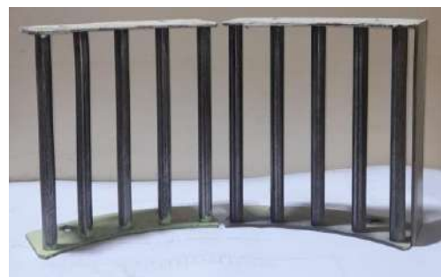
Решетка с круглыми колосниками диаметром 20 мм и шагом колосников 40 мм.
