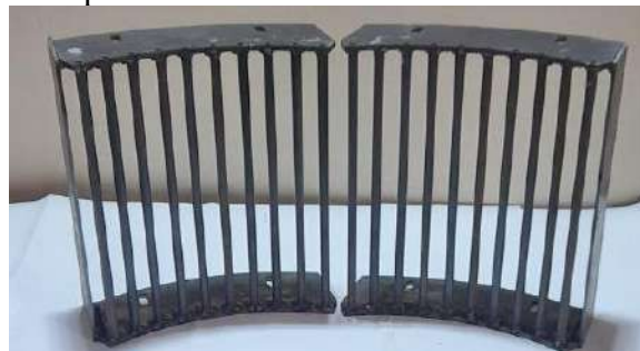
Решетка с круглыми колосниками диаметром 10 мм и шагом колосников 18 мм.
