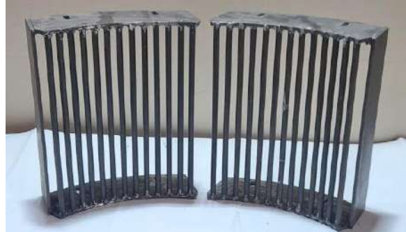
Diametri 10 mm va kolosniklar orasi 10 mm boʻlgan dumaloq kolosnikli panjara
