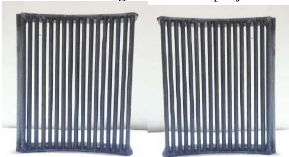
Diametri 10 mm va kolosniklar orasi 6 mm boʻlgan dumaloq kolosnikli panjara
