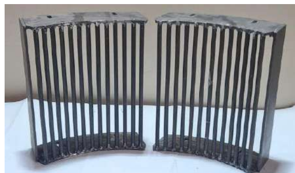
Решетка с круглыми колосниками диаметром 10 мм и шагом колосников 10 мм.
