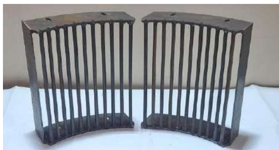
Решетка с круглыми колосниками диаметром 10 мм и шагом колосников 14 мм.
