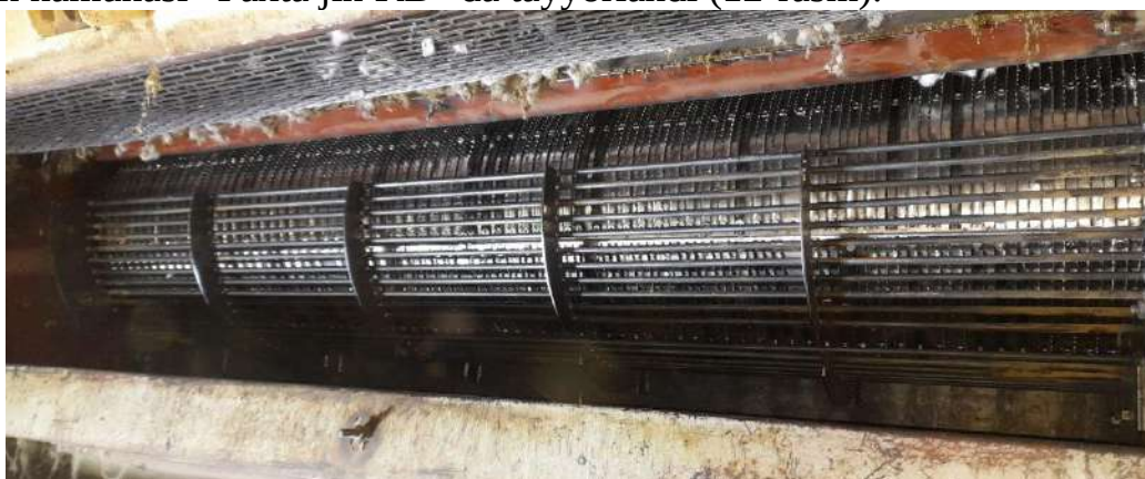
12-rasm. UXK uskunasi o'rnatilgan takomillashtirilgan kolosnikli panjaraning umumiy ko'rinishi.
