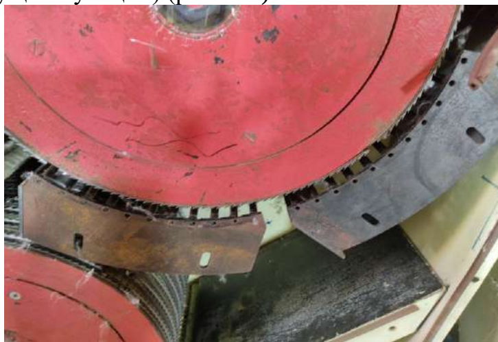
Рисунок 7. Вид колосников в исследовательском варианте, установленных на очистительном оборудовании ( d=10 ; l=14 )
