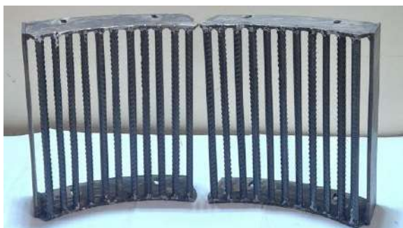
Решетка с арматурой диаметром 12 мм и расстояния между ними 12 мм
