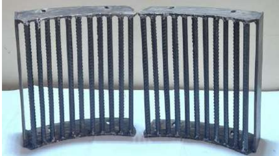
Diametri 12 mm armatura va kolosniklar orasi 12 mm boʻlgan kolosnikli panjara
