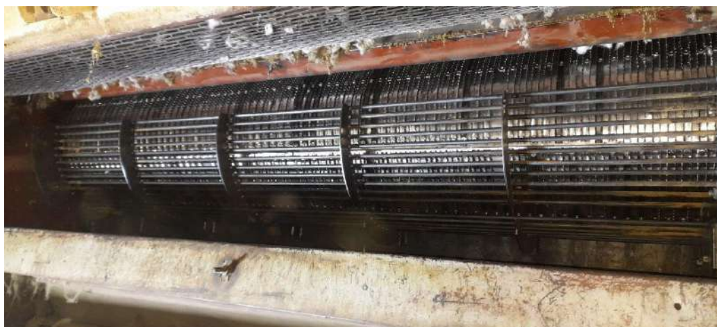
Рис. 12. Общий вид усовершенствованной колосниковой решетки, установленной на машине УХК
