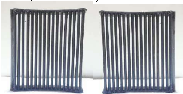
Решетка с круглыми колосниками диаметром 10 мм и шагом колосников 6 мм.
