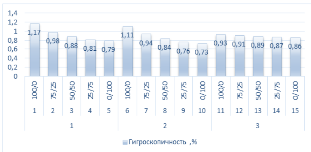
Рис.1. Значения гигроскопичности образцов трикотажных тканей
