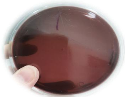
2-Rasm. Aloye ekstrakti bilan modifikatsiyalangan Mitkal matosining Escherichia coli (ichak tayoqchasi) bakteriyasiga bakterialogik taxlili natijasi.
