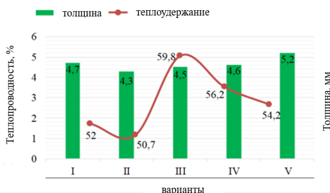
Рисунок 12. Гистограмма зависимости толщины и теплосохранности пальтового трикотажа
