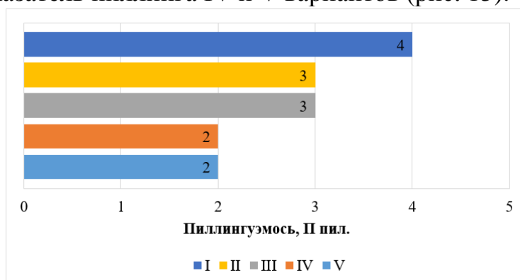
Рисунок 15. Гистограмма изменения пиллингирования пальтового интерлочного трикотажа
