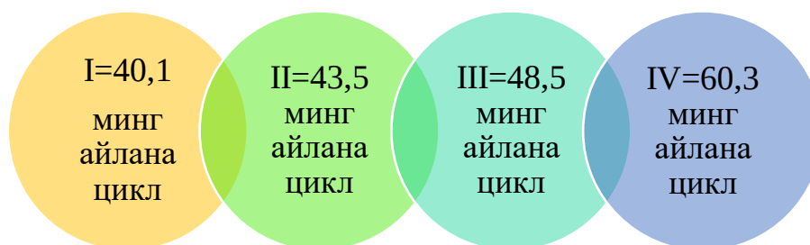
1-расм. Янги тузилишли пальтобоп трикотаж тўқималарининг ишқаланишга чидамлилиқ кўрсаткичлари.
