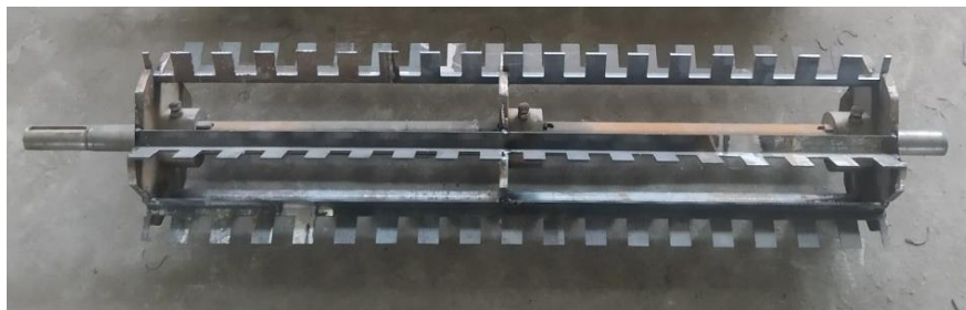
3-rasm Rezina-plankali barabanlarni o'rniga qo'yish uchun tayyorlangan plankali barabanni umumiy ko'rinishi
