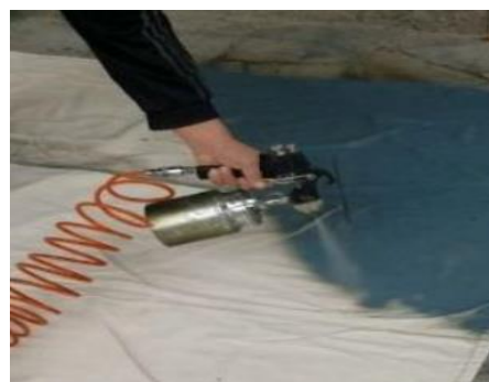
Рис.2. Вид процесса пневматического нанесения водного раствора латекса на парусину
