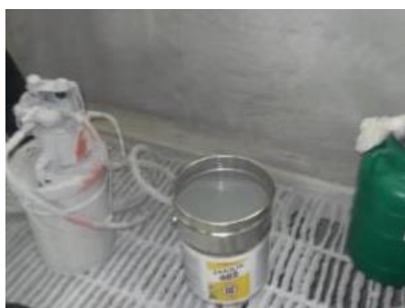
Рис.1. Процесс изготовления пропитываемого водного раствора латекса
