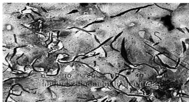
Рис. 3. Микроструктура рабочей поверхности колосника джина (X-500)
