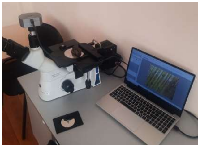
Рис. 11. а) общий вид металлографического микроскопа OXION INVERSO, б) фотография шлифа поверхности сменной пластины, сцементированной и насыщенной газообразным хромом
