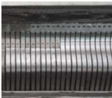
Рис. 16. Решетка с установленными испытуемыми колосниками.
