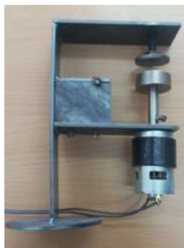
Рис. 9. Опытная установка для определения интенсивности изнашивания а- схема, б- общий вид
