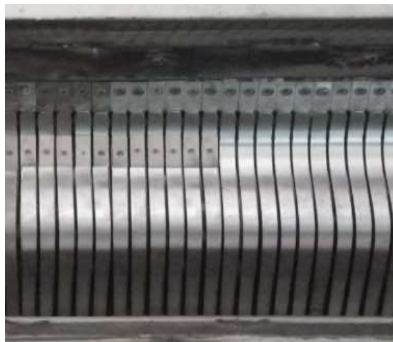
16-rasm. Sinovdan o'tayotgan kolosniklar o'rnatilgan panjara
